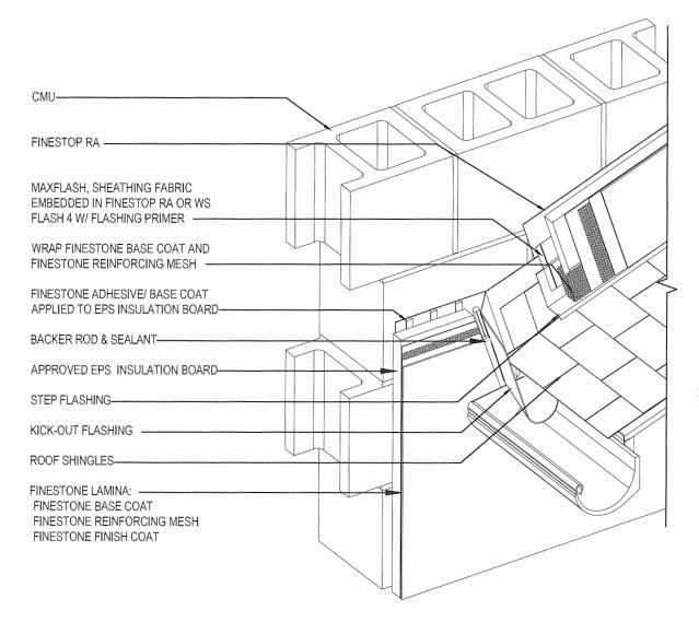
TYPICAL KICKOUT FLASHING DETAIL
