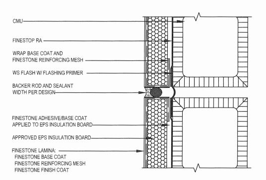
TYPICAL EXPANSION JOINT (PLAN VIEW)
